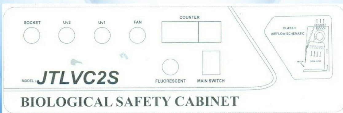
۱. کلید (MAIN SWITCH) در وضعیت  $\Phi N$  ( ) قرار دهید. درب کابین را با فاصله ۲ سانتیمتر از کف بسته نگهدارید.
